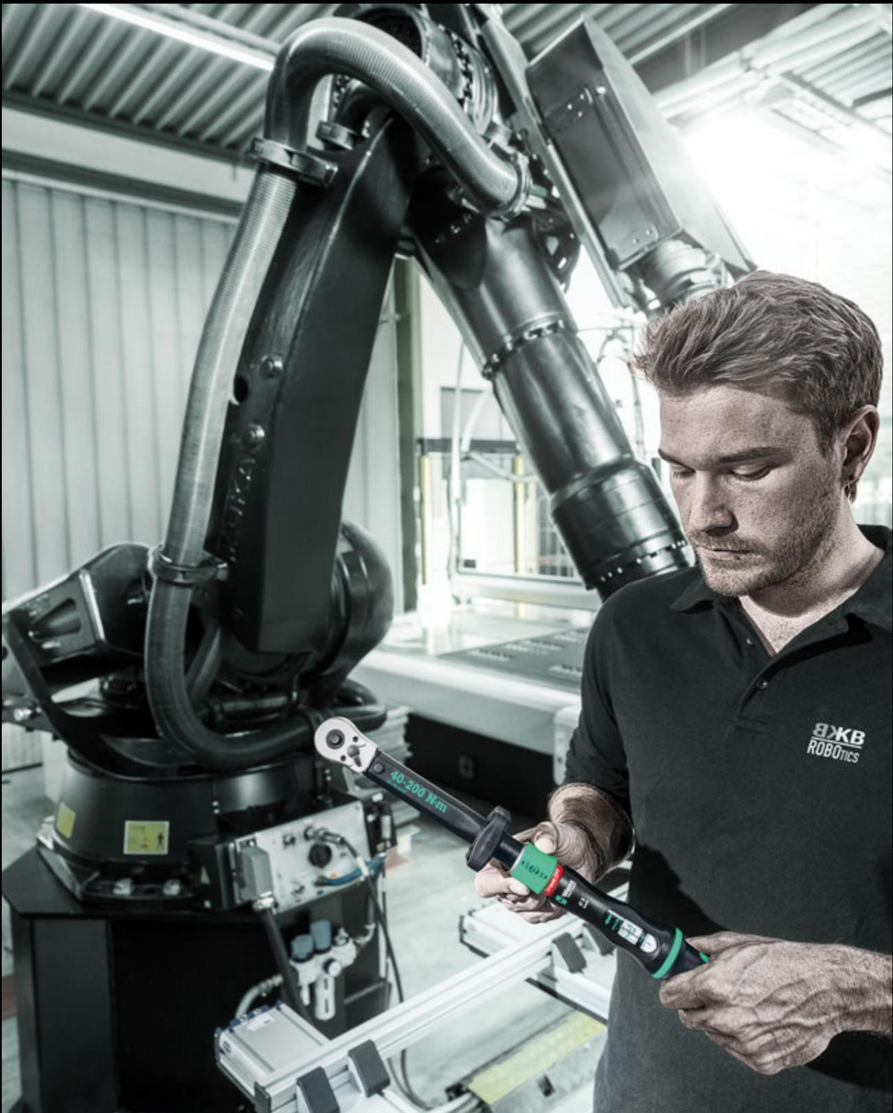
**Click-Torque Lock A 5 Llave dinamométrica, ajustable, función Torque Lock, carraca de conmutación, apriete hacia la derecha, 2,5-25 Nm**
