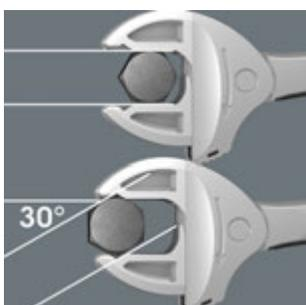
Por medio de los prismas angulares dentro de las dos bocas de la llave de doble boca, se consigue un ángulo de retorno de tan solo 30°.
