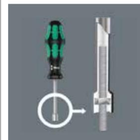
En todos aquellos casos en los que se trata de trabajos de atornillado en vástagos roscados, se necesita un destornillador con vástago hueco, ya que solo así el vástago roscado, por medio de la tuerca del tornillo, puede penetrar en el vástago hueco del destornillador.
