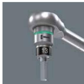
La sujeción del tornillo de hexágono exterior en la llave de vaso se realiza por medio de dos bolas elásticas y un tubo termoretráctil de permanente y de alta resistencia. El tubo está protegido contra el desgaste y rasgaduras por una anillo de acero frontal. La función de retención es especialmente
