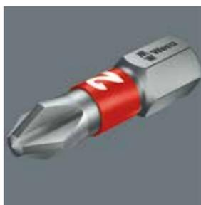
Puntas BiTorsion son las puntas Premium. Disponen de una zona BiTorsion más blanda, y así se consigue una reducción de la dureza del vástago en aproximadamente el 20 % con relación al extremo de la punta. De esta forma, los picos de par que causan el desgaste y la rotura prematura se absorben en esta zona más blanda lo que aumenta aún más la duración de vida de la punta.
