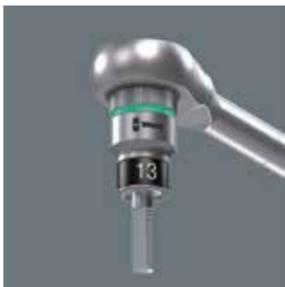
La sujeción del tornillo de hexágono exterior en la llave de vaso se realiza por medio de dos bolas elásticas y un tubo termorretráctil de permanente y de alta resistencia. El tubo está protegido contra el desgaste y rasgaduras por una anillo de acero frontal. La función de retención es especialmente
