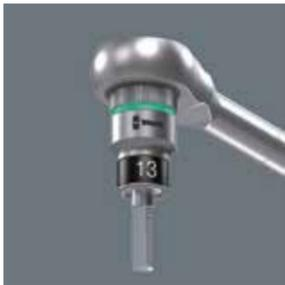
Le maintien de la vis hexagonale dans la douille à carré est assuré par deux billes élastiques et une gaine thermo-rétractable haute résistance à élasticité permanente.
