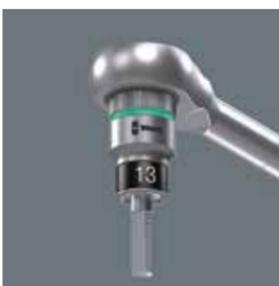
Le maintien de la vis hexagonale dans la douille à carré est assuré par deux billes élastiques et une gaine thermo-rétractable haute résistance à élasticité permanente. Celle-ci est protégée contre les endommagements mécaniques par une collerette d'acier située à l'avant. Particulièrement utile
