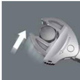
Grâce à ses mors parallèles auto-ajustable en continu, la clé mixte Joker 6004 remplace toutes les clés à fourche dans la plage de tailles correspondante. La clé s'ajuste d'elle-même, sans réglage, à la taille nécessaire au contact de l'écrou ou de la vis.
