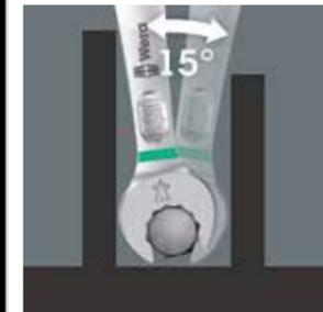
La clé mixte Joker 6003 avec la forme particulière de sa fourche dodécagonale et coudée à 7,5° double les possibilités d'ancrage lors de la rotation à 180° répétée de la clé dans l'axe longitudinal. Les écrous ou têtes de vis peuvent être « agrippés » tous les 15°. La Joker 6003 trouve pour ainsi dire d'elle-même le point d'ancrage suivant à chaque rotation.
