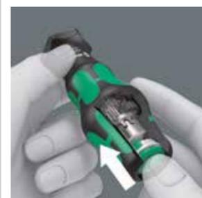
La fonction Turbo peut-être activée si nécessaire par simple pression d'un bouton. Il est recommandé de la désactiver avec les couples croissants ou pour le réglage de précision et le serrage ou desserrage final d'une vis à un couple élevé.
