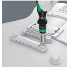
L'embout en acier inoxydable 3800/1 (1,8 x 12 x 41 mm) est idéalement conçu pour le réglage des vis avec lesquelles le chevalet est fixé. L'acier inoxydable empêche la formation de rouille erratique sur les pièces en acier inoxydable de la guitare.
