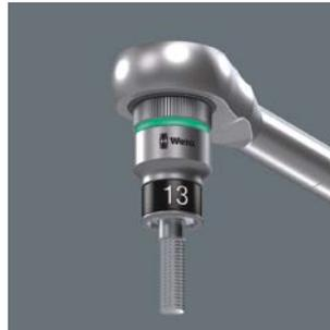
La sujeción del tornillo de hexágono exterior en la llave de vaso se realiza por medio de dos bolas elásticas y un tubo termoretráctil de permanente y de alta resistencia. El tubo está protegido contra el desgaste y rasgaduras por una anillo de acero frontal.
