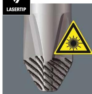
Con ayuda de rayos láser, se crea una estructura superficial de cantos afilados. Este tratamiento con láser proporciona una dureza de las ranuras de hasta 1000 HV 0,3. Lasertip de Wera se aferra en la cabeza del tornillo como si tuviera dientes, y de este modo evita la salida indeseada del destornillador de la cabeza del tornillo durante la acción del atornillado. En tornillos ranurados, Phillips y Pozidriv.
