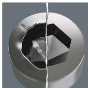
Los tornillos de hexagonal interior son problemáticos ya que las superficies de apoyo por medio de los cuales se transmite la fuerza de la herramienta al tornillo, son sumamente estrechas. Como consecuencia puede ser que se estropee la cabeza del tornillo. Las herramientas tipo
