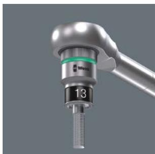
La sujeción del tornillo de hexágono exterior en la llave de vaso se realiza por medio de dos bolas elásticas y un tubo termorretráctil de permanente y de alta resistencia. El tubo está protegido contra el desgaste y rasgaduras por una anillo de acero frontal. La función de retención es espe-
