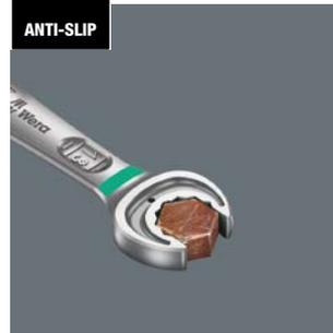
La inteligente geometría de doble hexágono de la Joker produce una unión perfecta y continua con el tornillo o la tuerca ¡esto sí que encaja bien!. Y la placa metálica intercambiable y endurecida de la que dispone la boca de la Joker, con ayuda de sus puntas extremadamente duras, se aferra fuertemente en el tornillo. Ambas cosas evitan las molestias que provocan los deslizamientos incluso en pares de apriete muy elevados.
