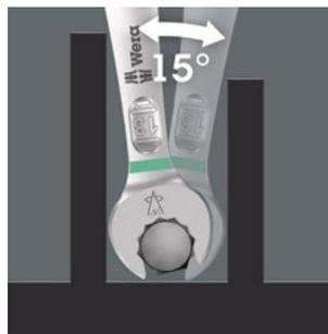
La clé mixte Joker 6003 avec la forme particulière de sa fourche 12 pans et coudée à 7,5° double les possibilités d'ancrage lors de la rotation à 180° répétée de la clé dans l'axe longitudinal. Les écrous ou têtes de vis peuvent être « agrippés » tous les 15°. La Joker 6003 trouve pour ainsi dire d'elle-même le point d'ancrage suivant à chaque rotation.
